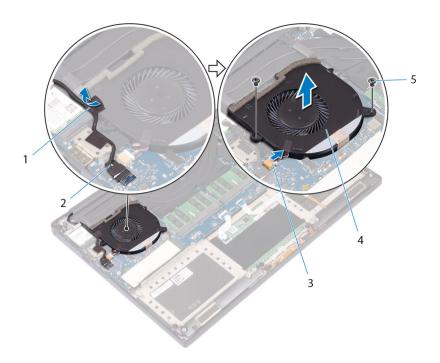
Figure 18. Removing the right fan
