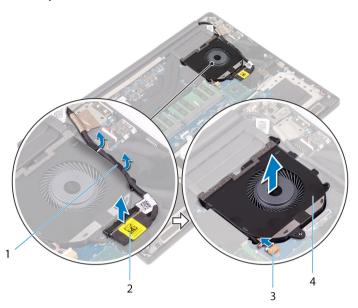
Figure 20. Removing the left fan
